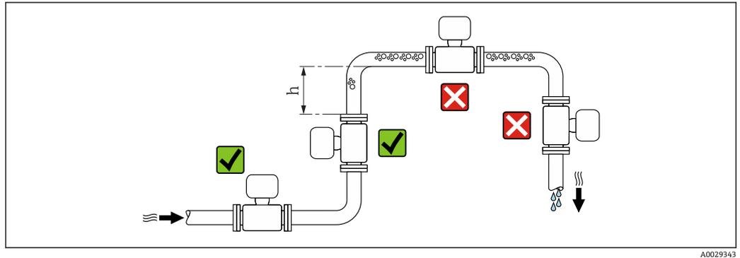
建议将传感器安装在介质自下向上流动的管道中，并确保与相邻管道弯头间保留有足够的间距： $h \geq 2 \times DN$ 。
