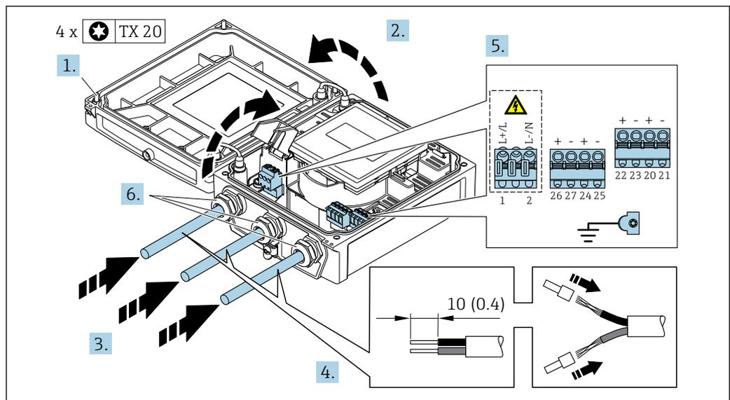
图 19 电源和 0...20 mA / 4...20 mA HART 的连接示意图，带附加输出和输入
