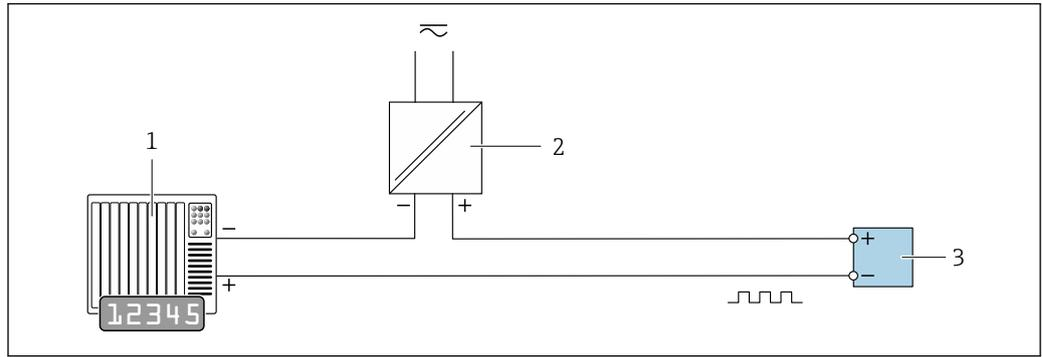
图 25 脉冲/频率输出(无源信号)的连接实例
