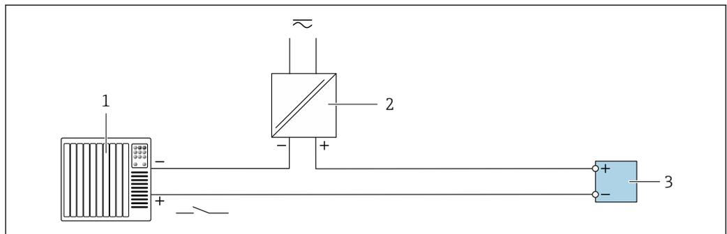
图 27 状态输入的连接实例
