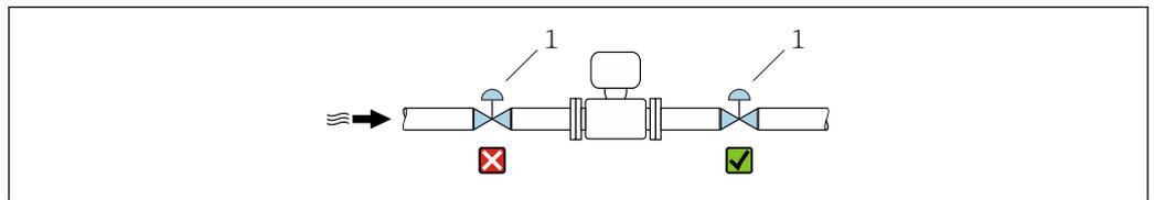
**4** 不建议将传感器安装在控制阀后方。
