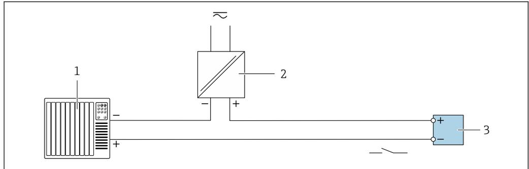
图 26 开关量输出(无源信号)的连接实例
