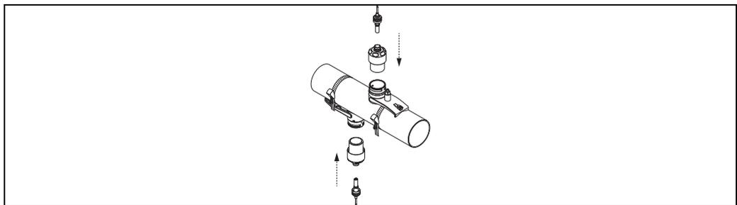
图 41: 安装传感器，连接连接电缆
