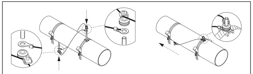
图 38: 安装捆绑带 (步骤 2...4)
