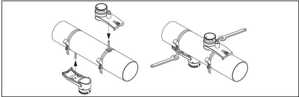
图 30: 安装传感器安装基座
