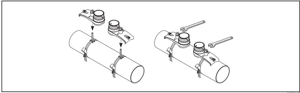
图 43: 安装传感器
