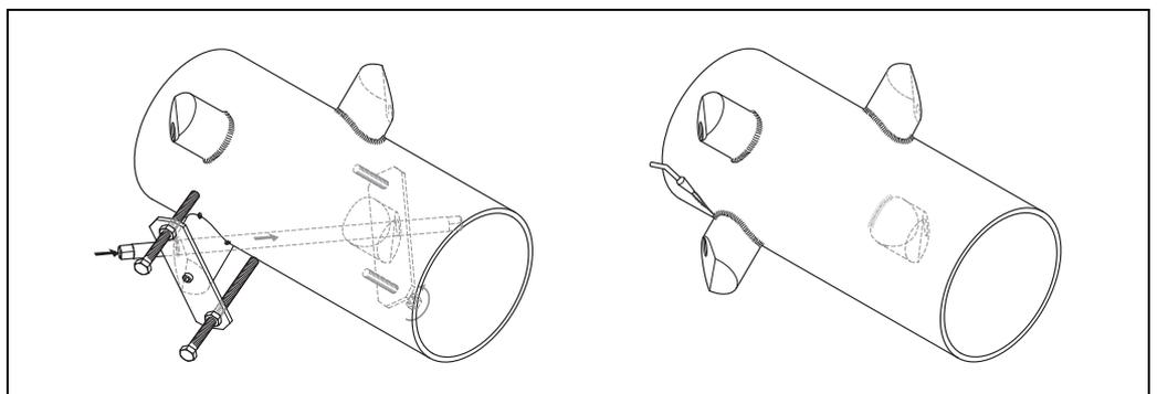
图 60: 安装双声路测量传感器，步骤 14
