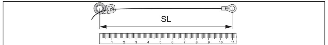
图 28: 固定器 (a) 和电缆接线头 (b) 间的距离等于线长 (SL)
