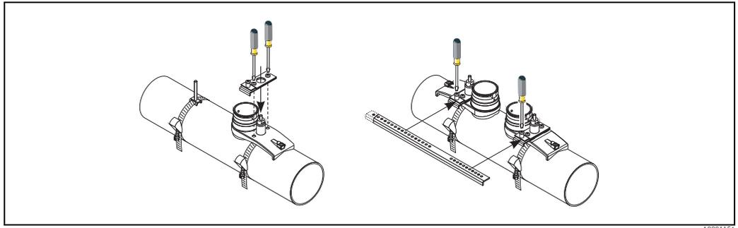
图 34: 安装传感器安装基座和安装导轨尺
