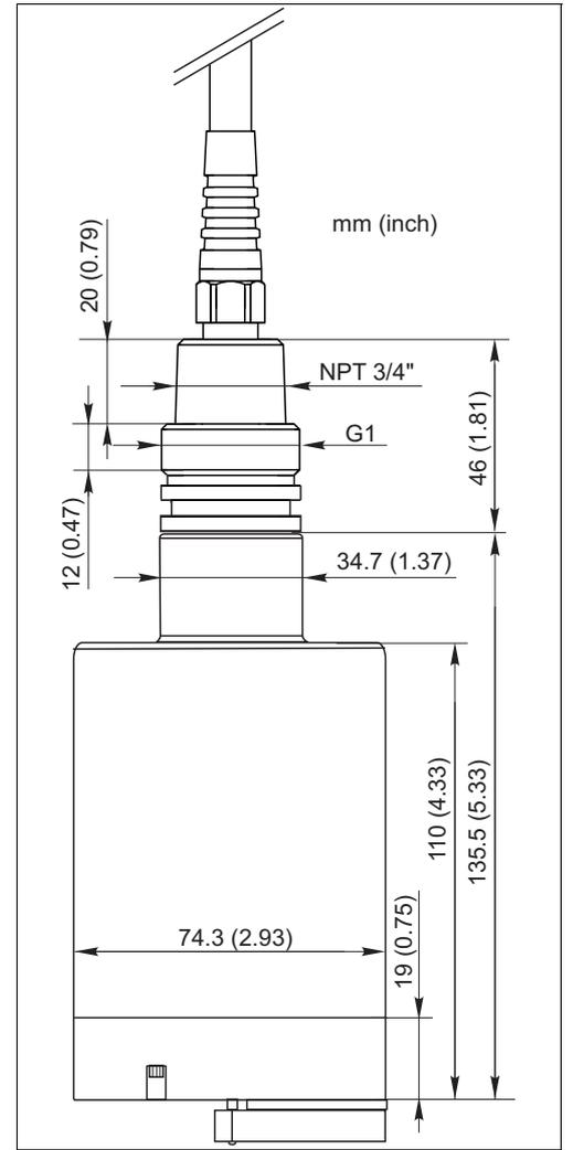
带刮刷的传感器的外形尺寸示意图
