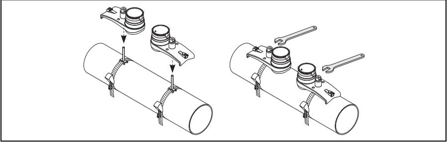
图 19：安装传感器
