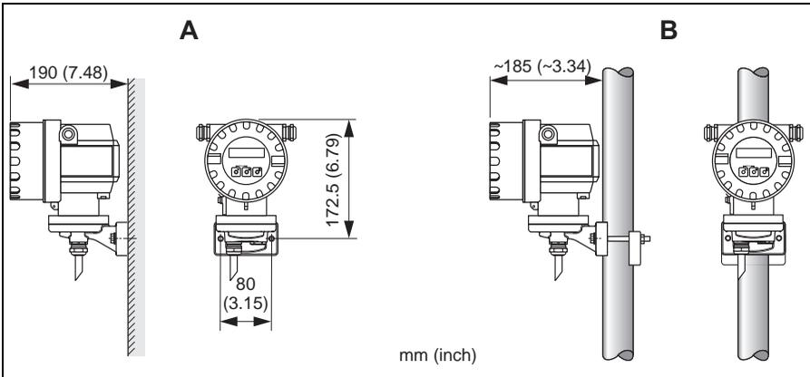
图 4：安装变送器
