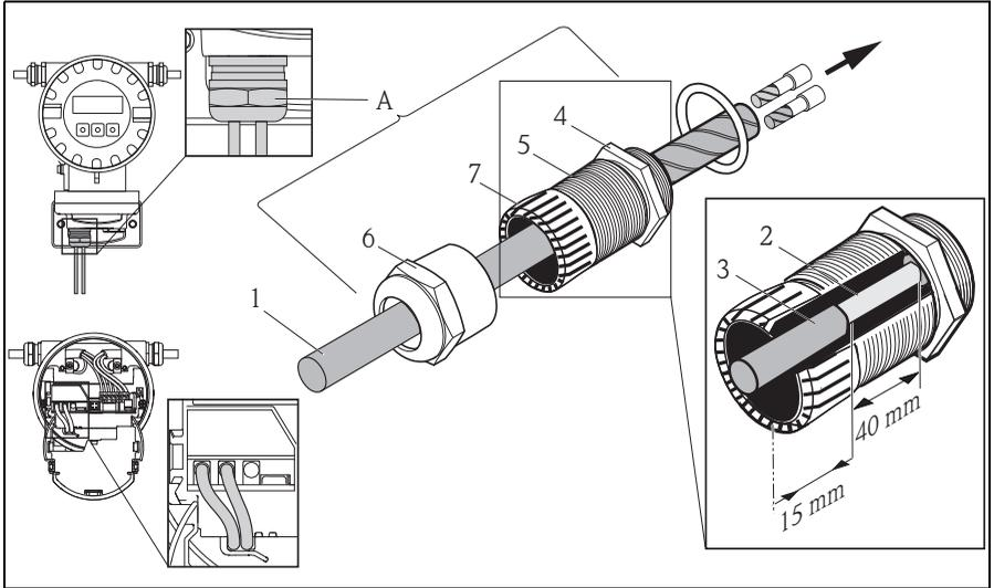
图 23：测量系统的连接和接地 (DN15 - 65)
