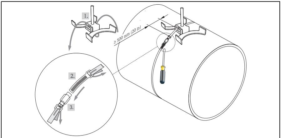
图 9: 预装捆绑带: 管道直径  $DN > 600$  (24")
