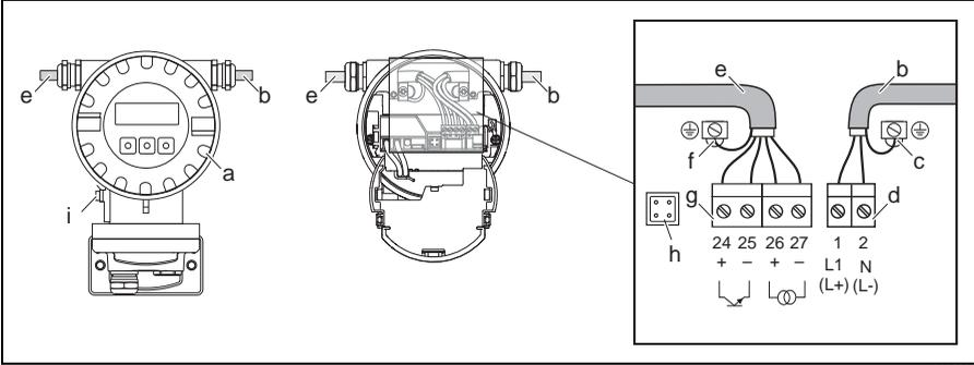
图 25: 连接变送器 (铝质现场外壳)。电缆横截面积: max. 2.5 mm<sup>2</sup> (AWG 14)
