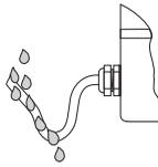
电缆进入缆塞之前，必须向下弯曲（“聚水器”）。
