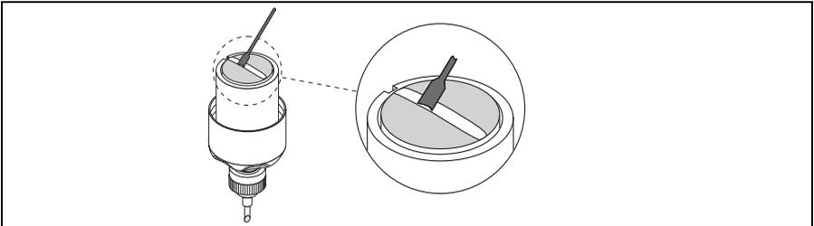
图 20：在传感器接触表面涂上耦合剂
