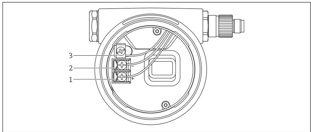
图 2 接线腔内的接线端子和接地端子
