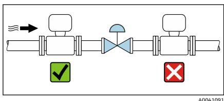
参照介质流向，将仪表安装在控制阀门的上游管道中。
