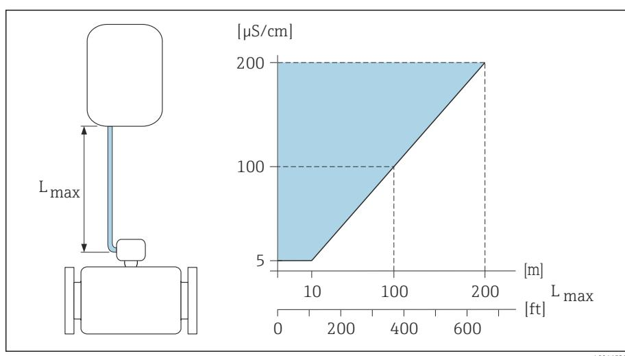
图 9 允许连接电缆长度
