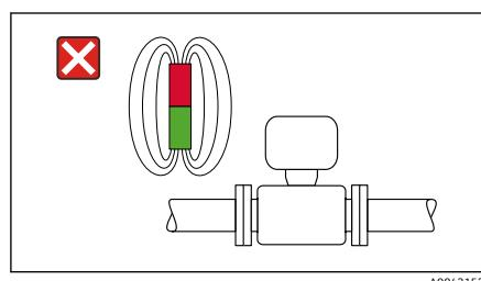
禁止将仪表安装在磁场源附近，例如电机、泵、变压器。
