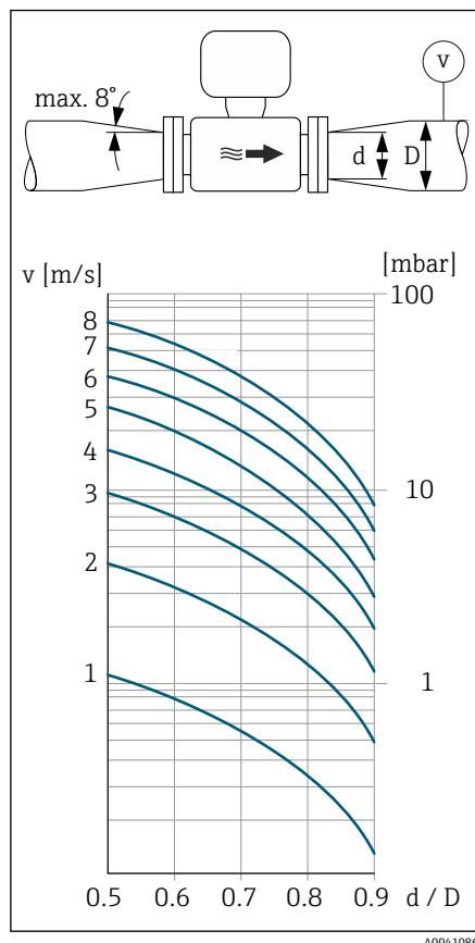
可以使用合适的转接管（双法兰缩径管）将传感器安装在更大口径的管道中。这样可以增大进入传感器的介质流速，提升极慢速流动介质的测量精度。
