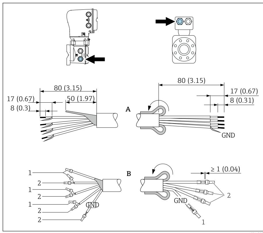
1. 确保线鼻子不会接触到传感器端的电缆屏蔽层。满足 1 mm 的最小间距要求（绿色接地电缆除外）。
