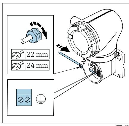
3. 将供电电缆和电极电缆接入相应电缆入口。
