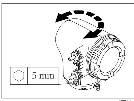
1. 松开变送器外壳两侧的固定螺栓。
