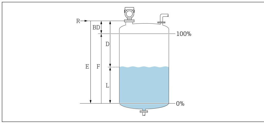
图 10 液位测量的设置参数
