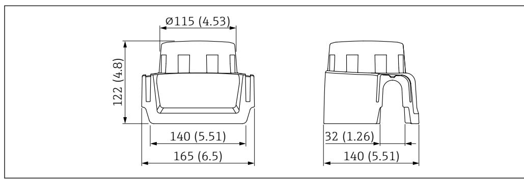
图 14 外形尺寸示意图。测量单位 mm (in)
