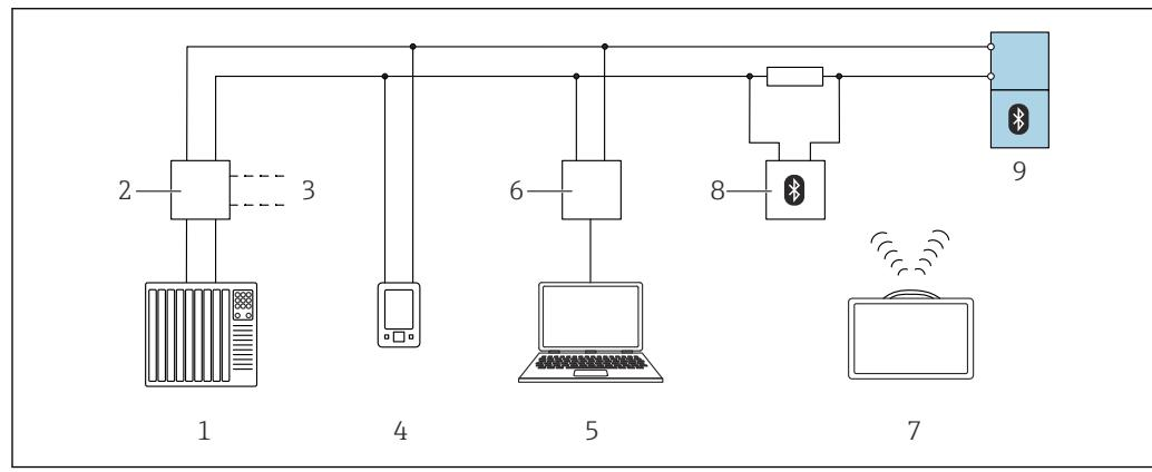
**图 9 通过 HART 通信实现远程操作**
