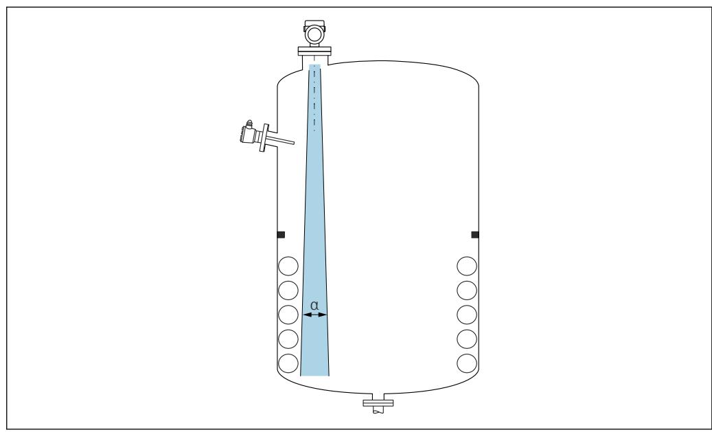
在信号波束范围内避免安装任何内部装置（例如限位开关、温度传感器、立杆、真空环、加热盘管、挡板等）。注意波束角  $\alpha$ 。
