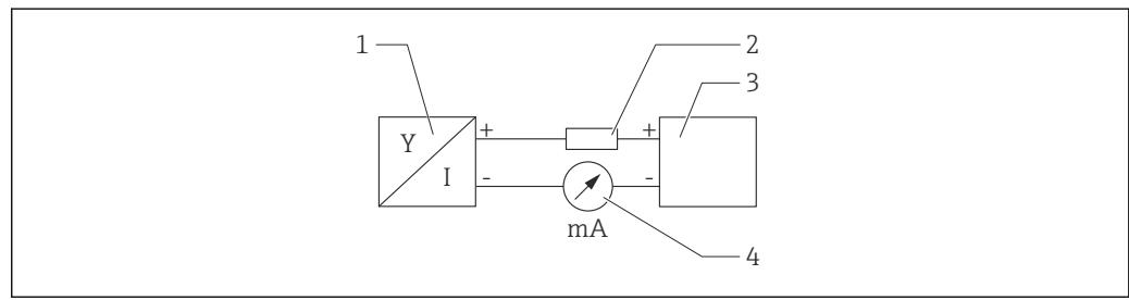
图 3 HART 信号回路连接框图
