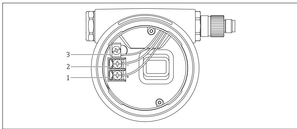
图 4 接线腔中的接线端子和接地端
