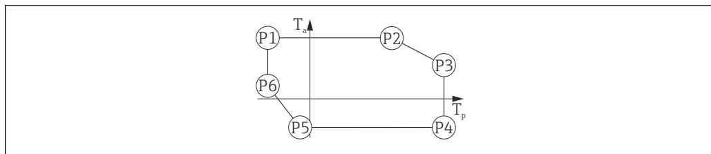
图 46 316L 外壳材质; 过程温度范围:  $-196 \dots +200^\circ\text{C}$  ( $-320 \dots +392^\circ\text{F}$ )
