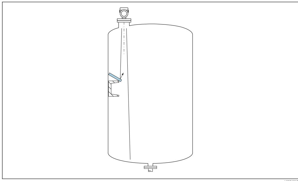
倾斜安装的金属反射板能够散射雷达波信号，有助于减少干扰回波。
