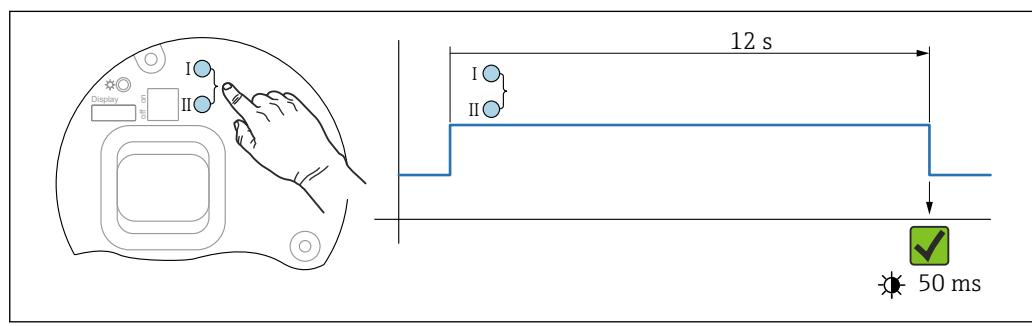
图 12 电子插件上的操作按键
